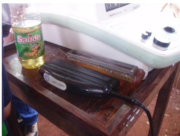
Aparelho de US, guia acústica (stand off) , transdutor (probe) e óleo vegetal
